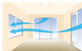
開口部を3面に設けると、風向きに影響されず換気ができる。
