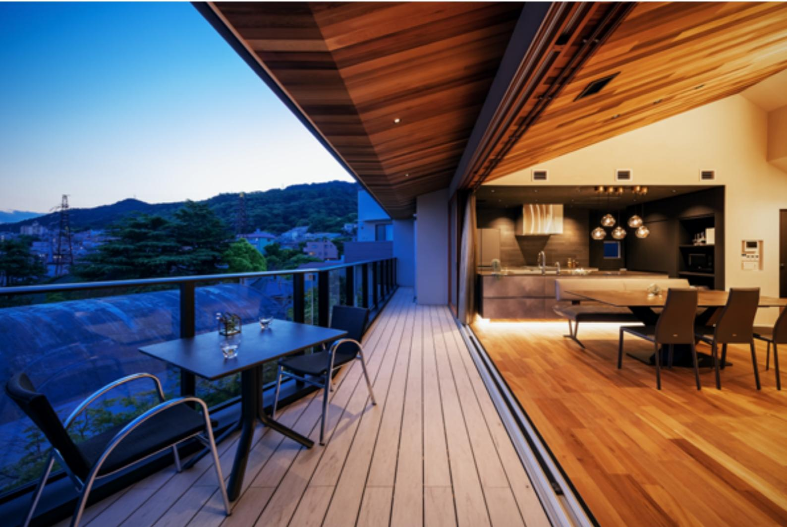
「絶景テラスの家」天井のレッドシダーが 1.2m ある深い軒先まで伸びることで屋内と屋外が繋がる。開口部は幅 4.9m × 高さ 2.5m のフルオープンする木製サッシ。南向きの太陽に素直な設計となっている 写真／福澤昭嘉
